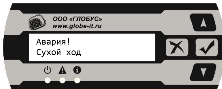
Рисунок 21. Оповещение об аварии
